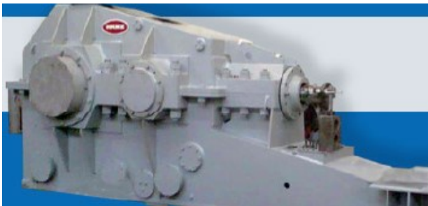
Редуктори привідних станцій ЦПТЛ типу КЦД-90
