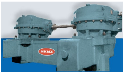
Редуктор приводу установки верхнього валка кліті тріо
